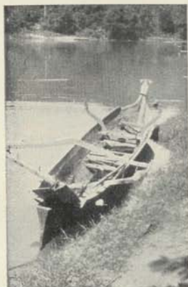
7. Sampan met V-vormige doorsnede te Reo.
