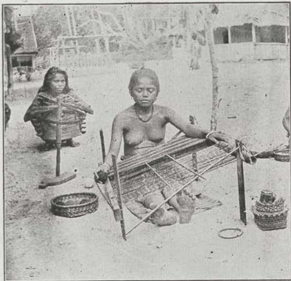
Op den voorgrond het scheren van den ketting. Op den achtergrond een meisje bezig met haspelen. De haspel door haar gebezigd is wat beter bewerktuigd dan de vorige. In een bamboekoker, die op de spil draait, zijn verstelbare stokjes ingewerkt, voorzien van ingekeepte hangers om de streen garen te bevestigen.
